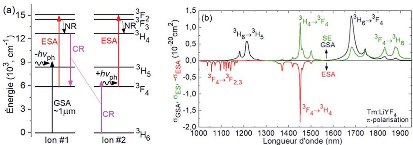
**Figure 4.** (a) schéma de pompage par « upconversion » d'ions thulium basé sur le mécanisme d'avalanche de photons, GSA et ESA : absorption dans l'état fondamental et dans l'état excité, respectivement ; (b) Spectres de GSA et d'ESA dans un cristal Tm:LiYF<sub>4</sub> pour la polarisation  $\pi$ .
