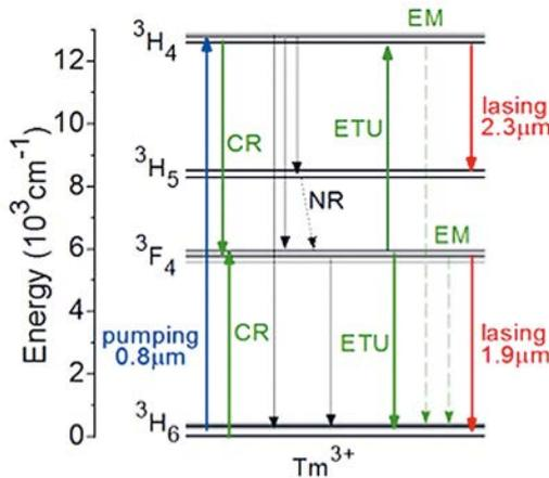
**Figure 1.** Schéma simplifié des niveaux d'énergie des ions  $Tm^{3+}$  dans  $LiYF_4$  : flèches bleues et rouges - transitions de la pompe et du laser, respectivement, flèches noires pleines - relaxation radiative (R), flèche noire en pointillés - relaxation non radiative (NR), flèches vertes - relaxation croisée (CR), upconversion par transfert d'énergie (ETU), migration d'énergie (EM).
