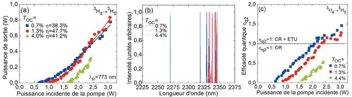
**Figure 3.** Laser Tm:KY<sub>3</sub>F<sub>10</sub> fonctionnant sur la transition  ${}^3\text{H}_4 \rightarrow {}^3\text{H}_5$ : (a) dépendance entrée-sortie,  $\eta$  – rendement laser ; (b) spectre d'émission laser typique ; (c) Efficacité quantique de la pompe calculée  $\eta_{q2}$  impliquant le rôle de l'ETU. L'émission laser est non polarisée, la longueur d'onde de la pompe  $\lambda_p$  est de 773 nm.
