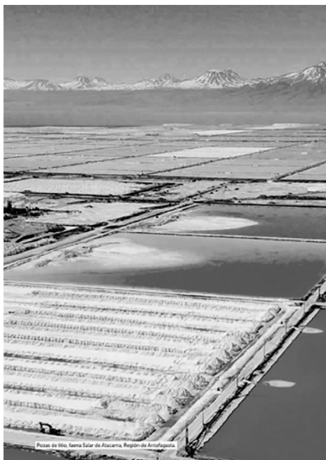
Figura 3. Concentración de litio por evaporación solar (SQM, 2020: 42).
