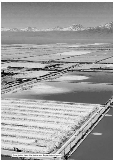
Figura 3. Concentración de litio por evaporación solar (SQM, 2020: 42).
