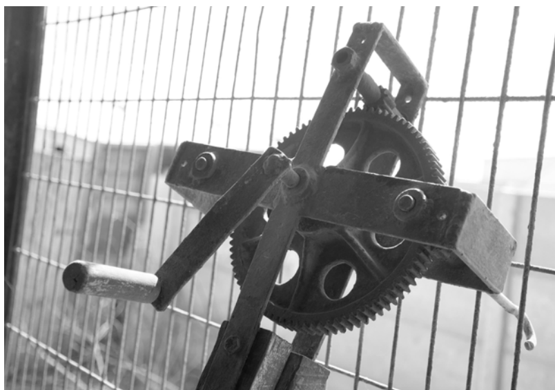
Figura 3. Herramienta para torcer cabos. El rolete permite obtener cordeles o cabos de diferentes grosores.
