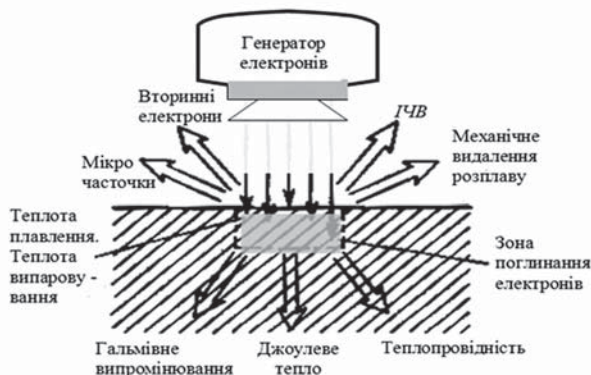
Рис. 1. Спосіб радіаційної обробки тонких полімерних плівок з металевим конвертором
