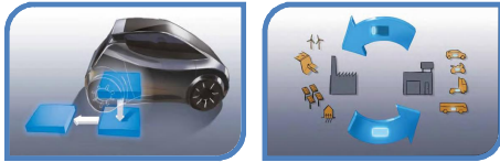
Recharge de carburants métalliques et filière de production/recyclage du matériau énergétique.
