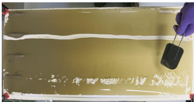
Figure 9 : Sous-échantillonnage en bande sur toute la longueur de la feuille de Téflon pour l'analyse de la distribution granulométrique des matières en suspension prélevées par centrifugation.
