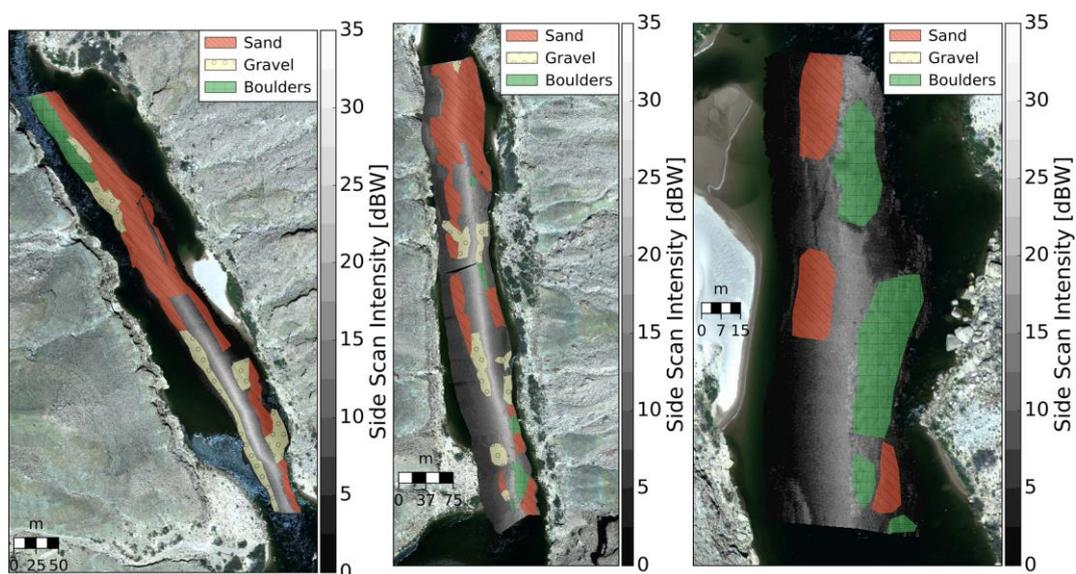
Figure 13. Exemple de cartographie manuelle du substrat à partir d'un sonagramme. (Source : Hamill et al. (2016)).
