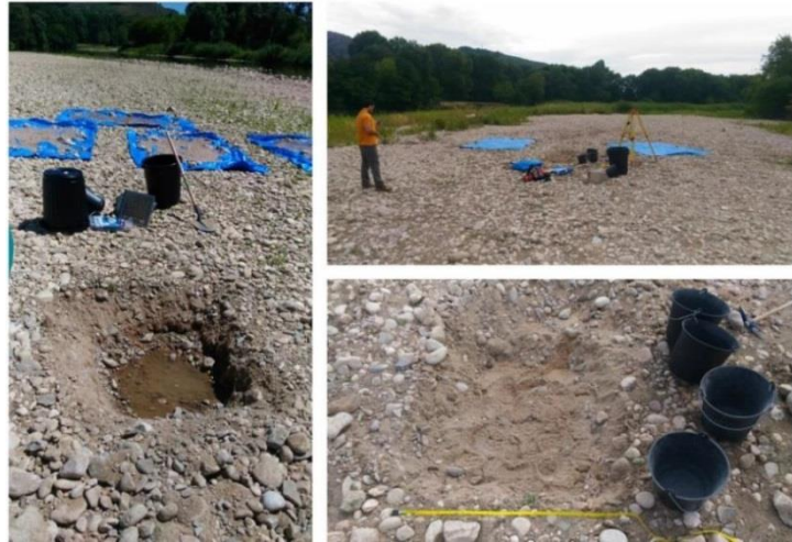
Figure 4. Dispositif mis en place pour l'échantillonnage massif en milieu émergé, sur le Doux. (Source : Rapport A1.3 de l'OSR4)
