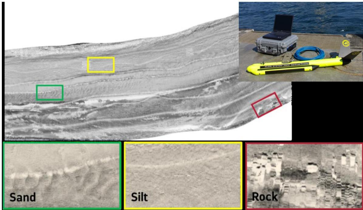
Figure 15. Sonar latéral CNR et exemple d'acquisition.
