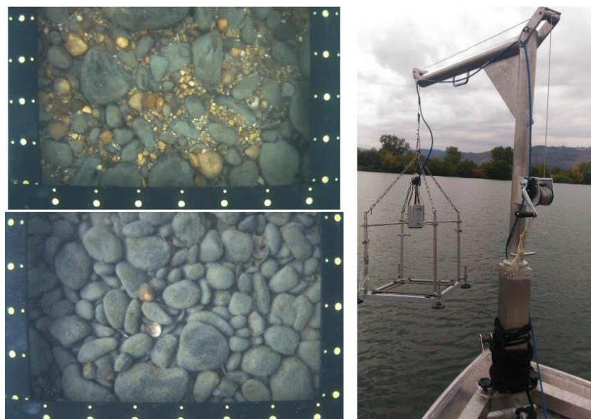
Figure 9. Dispositif CNR (à droite) et exemples de prise de vue immergée (à gauche).
