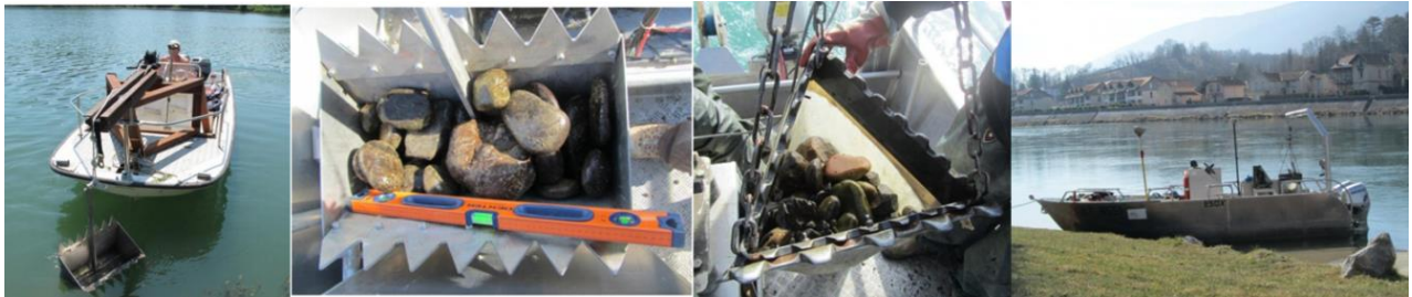
Figure 5. Dispositif d'échantillonnage massif subaquatique composé d'une embarcation tractant un préleveur Cooper Scooper, à gauche ou une drague « CNR », à droite (Clichés : E. Parrot 2015 – OSR1 et 2).
