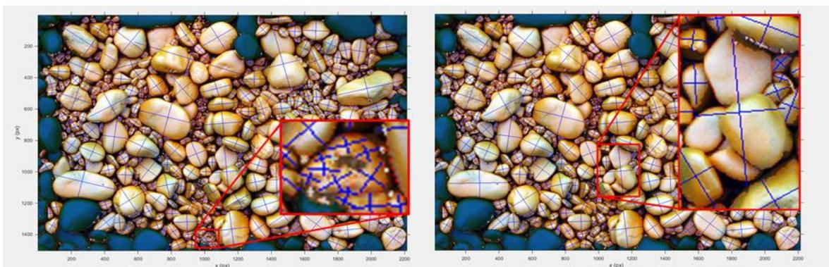
Figure 23. Exemple de sur- (à gauche) et sous-segmentation (à droite) de particules avec *BaseGrain*.
