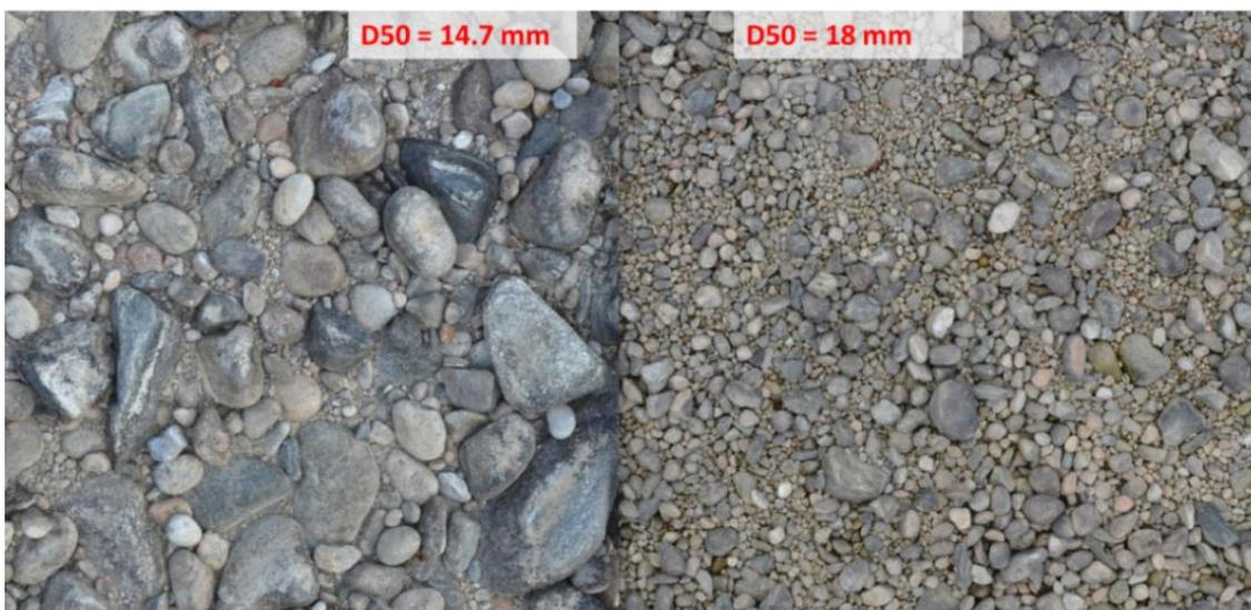
Figure 19. Exemple de deux images aux particules grossières et à la lithologie hétérogène et grenue. Les D50 ont été obtenus par mesures automatiques par ondelette.
