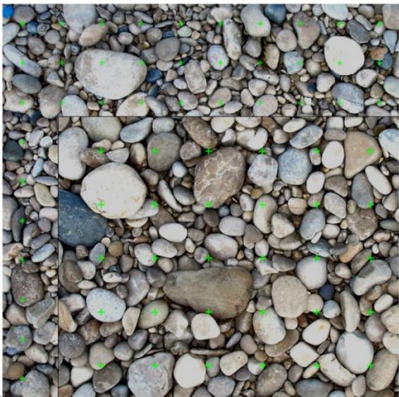
Figure 24. Capture d'écran du logiciel Granulo Analyzer avec les croix d'identification des nœuds du quadrillage pour la sélection des particules à échantillonner et l'encart de zoom.
