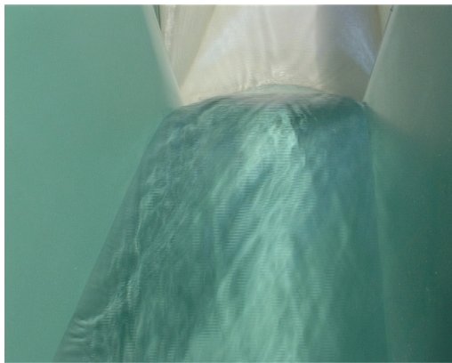
Vue de la section de mesure du venturi
