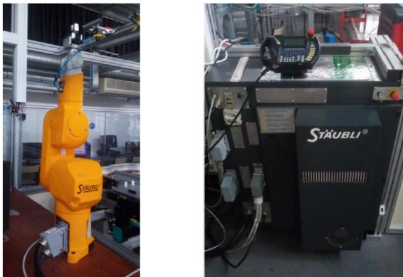
Figure 3. Bras robot RX60L et son contrôleur CS8
