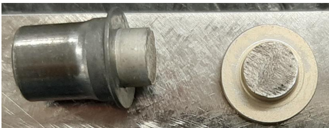
Figure 3. PHOTO D'UNE FIXATION CISAILLEE PENDANT UN ESSAI
