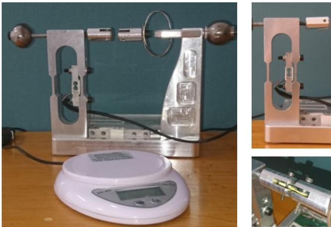
Figure 8. BANC DE TEST DES CROCHETS
