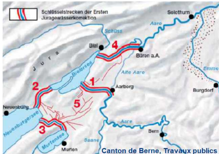
Figure 11 : Premiers « travaux de correction des eaux du Jura » sur la période 1868-1891 : 1. Dérivation de l'Aar dans le lac de Biènné ; 2-3-4. Travaux de correction en amont-aval des lacs ; 5. Assèchement de marais (source www.bafu.admin.ch/dangersnaturels )
