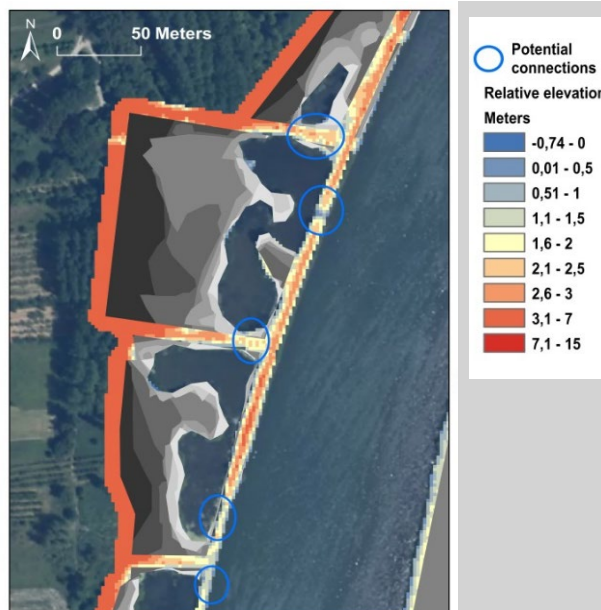
Figure 19 : exemple de points bas dans les digues et motifs concentriques à PDR (Source : Seignemartin, 2020)
