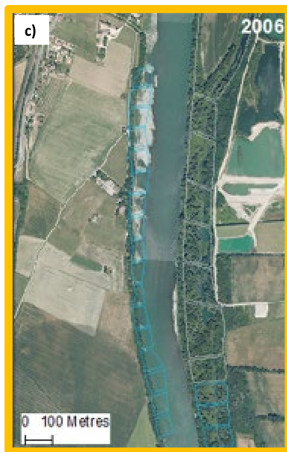
Figure 21 Un relèvement de l'altitude de la ligne d'eau après la construction des casiers (a) maintient leur connexion avec le chenal et réduit le processus d'atterrissement (b). La baisse du niveau d'eau du scénario iii à iv (a) se traduit par un fort atterrissement après dérivation (c). Le bas du rectangle en (a) montre l'incision moyenne et le haut montre l'altitude de l'eau, tous deux comparés à la condition initiale (scénario i) ; par conséquent, la hauteur de chaque barre d'erreur représente la variation de la profondeur de l'eau par rapport au premier scénario. En (b, c), les lignes bleues indiquent les champs ouverts, les lignes grises indiquent les champs fermés à DZM (PK 181,5)
