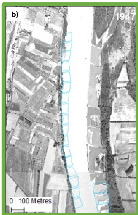
Figure 21 Un relèvement de l'altitude de la ligne d'eau après la construction des casiers (a) maintient leur connexion avec le chenal et réduit le processus d'atterrissement (b). La baisse du niveau d'eau du scénario iii à iv (a) se traduit par un fort atterrissement après dérivation (c). Le bas du rectangle en (a) montre l'incision moyenne et le haut montre l'altitude de l'eau, tous deux comparés à la condition initiale (scénario i) ; par conséquent, la hauteur de chaque barre d'erreur représente la variation de la profondeur de l'eau par rapport au premier scénario. En (b, c), les lignes bleues indiquent les champs ouverts, les lignes grises indiquent les champs fermés à DZM (PK 181,5)
