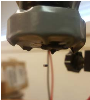
fig 4 : Le dispositif maintient en position d'équilibre un aimant de 5 milligrammes (hauteur : 1mm, diamètre : 1mm)
