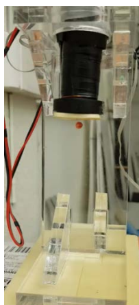
fig 1 : Le dispositif est constitué d'une bobine instrumentée de deux capteurs à effet Hall à chaque pôle (ref : A1324), d'une carte électronique de puissance et d'une carte Arduino. Il permet de maintenir en lévitation magnétique un aimant de quelques milligrammes.
