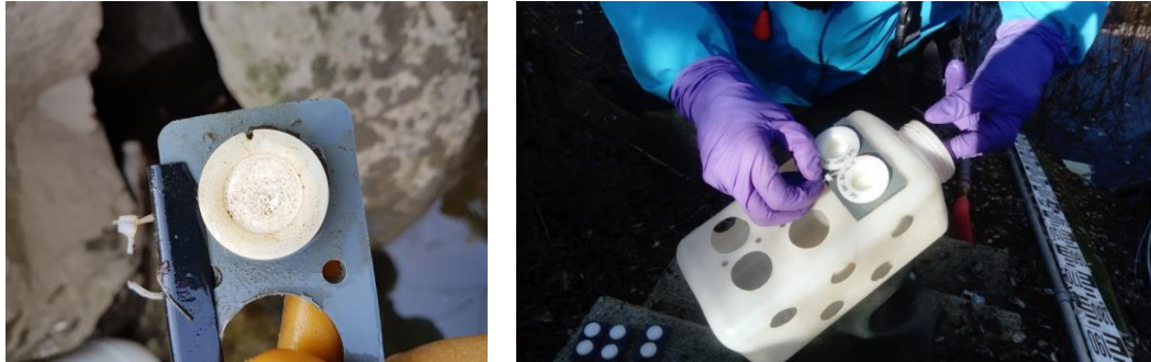
Figure 1 : DGT fixé sur son support en PVC et système de déploiement utilisé pour déployer les différents types de DGT.
