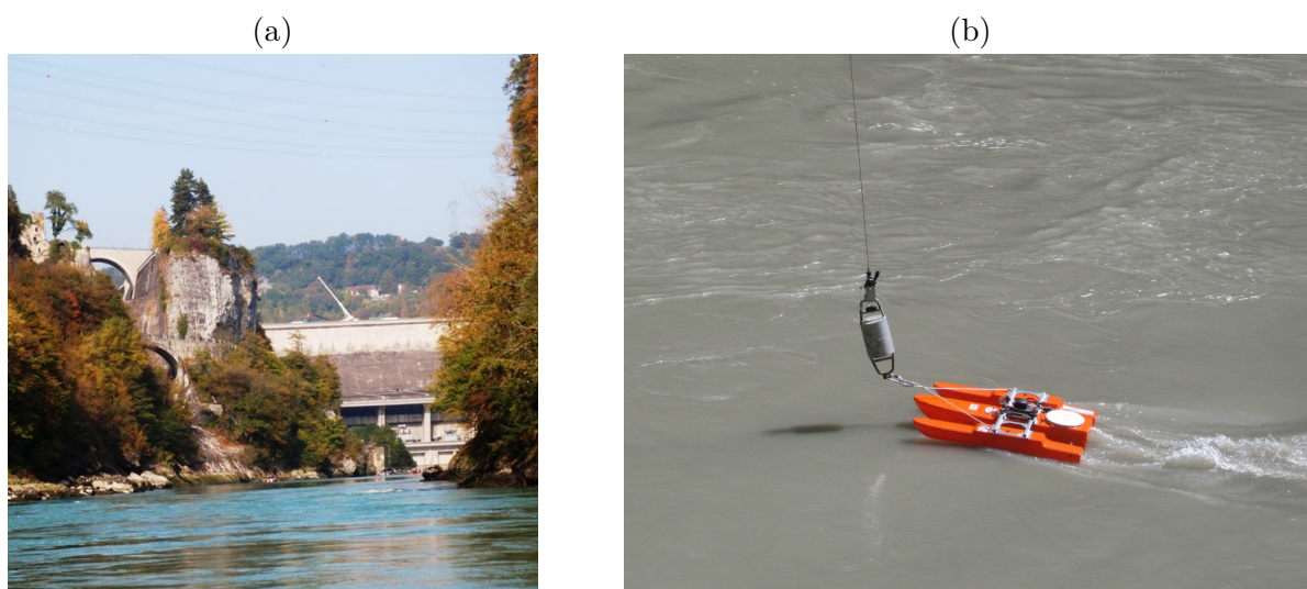
FIGURE 2.4. Barrage de Génissiat vue de l'aval (2010) (a). Mesures ADCP pendant l'APAVÉR en mai 2016 depuis la traile téléphérique de Bognes (b).
