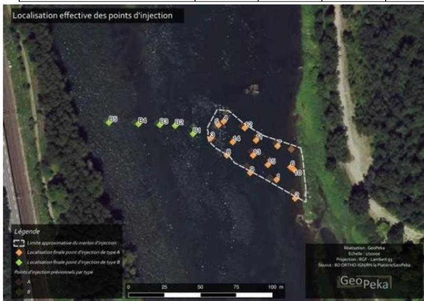
**Figure 8. Localisation des clusters de traceurs sur le site de réinjection de sédiment de la Platière.**
