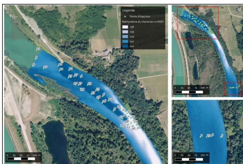
Figure 2. Localisation des injections des traceurs à Motz en fonction de la bathymétrie initiale (Source : GeoPeka).
