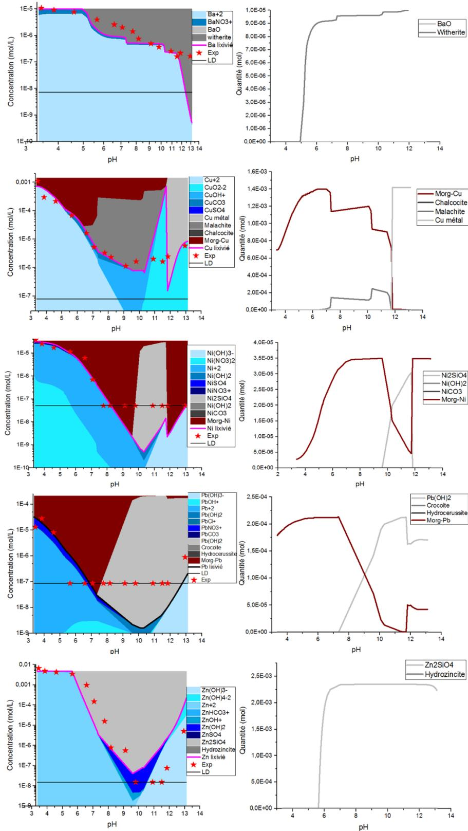
**Figure 2. Solubilité et spéciation du Ba, Cu, Ni, Pb et Zn en fonction du pH (L/S = 10 L.kg<sup>-1</sup>) (droite) : Les résultats expérimentaux sont présentés par une étoile, la spéciation des ETM en phase liquide est présentée par différentes nuances de la couleur bleue ; les phases minérales sont présentées en gris et le complexe MO-ETM est en marron. La limite de détection (LD) est présentée aussi. A gauche, les phases minérales contenant ces éléments.**
