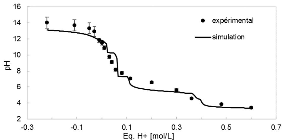
**Figure 1. Evolution du pH expérimental et simulé lors du test ANC en fonction de l'acide et de la base ajoutés (Eq. H<sup>+</sup>). (L/S = 10 L.kg<sup>-1</sup> ; temps de contact = 185 h).**
