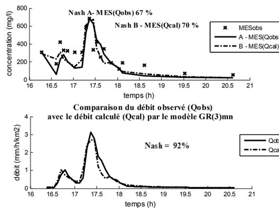
Figure 1. Ajustement de la concentration des MES (en haut) et du débit (en bas) en validation partielle. Concentration calculée en fonction du débit observé et calculé par GR(3)mn.
