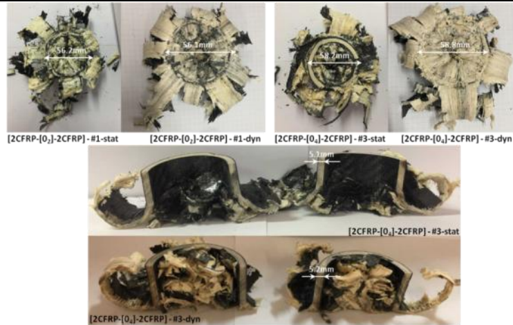
Fig. 4. Comparaison statique et dynamique du mode de ruine
