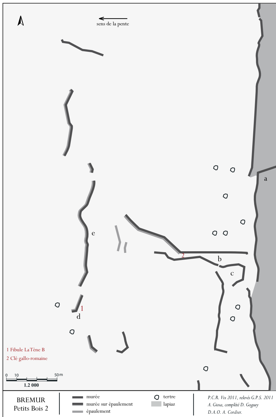
Fig. 13 : Petits Bois 2 (Brémur) : à l'est, le lapiaz est contenu par une murée (a) ; au centre, un chemin (b) aboutit à des terrasses et s'arrête au niveau d'une longue terrasse ; la portion (d) est aménagée par un renforcement du soutènement.
