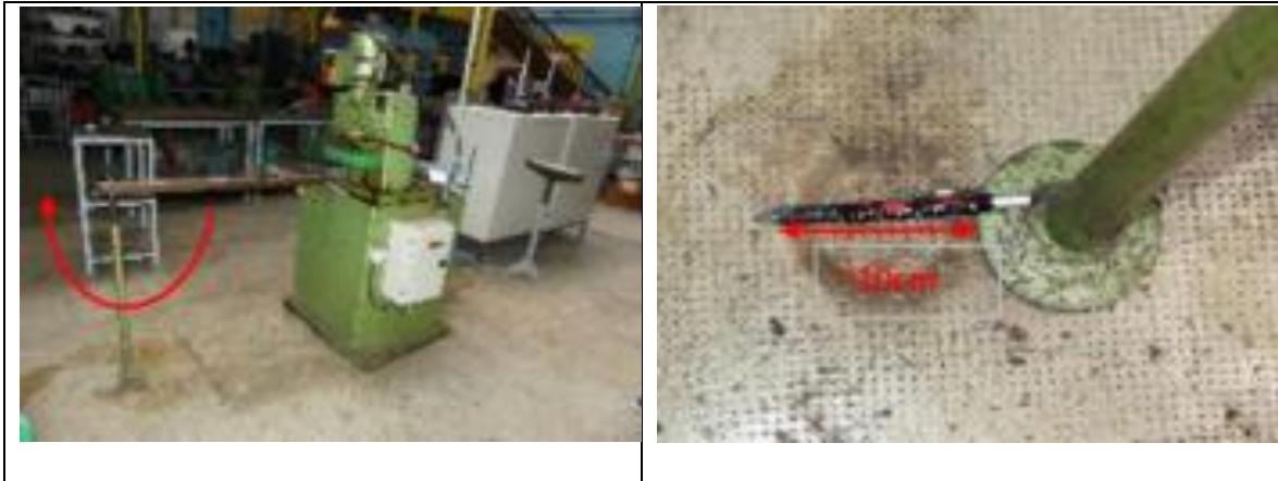
Figure 6-33 : Équipements ayant subi un déplacement et une rotation par rapport à la position initiale.
