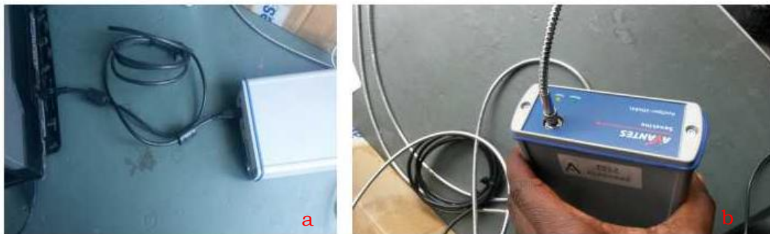
Figure 3. Le spectromètre AVANTES ULS2048XL-USB utilisé dans la prise des mesures. Connexion PC-spectromètre (a), connexion Fibre-spectromètre (b)
