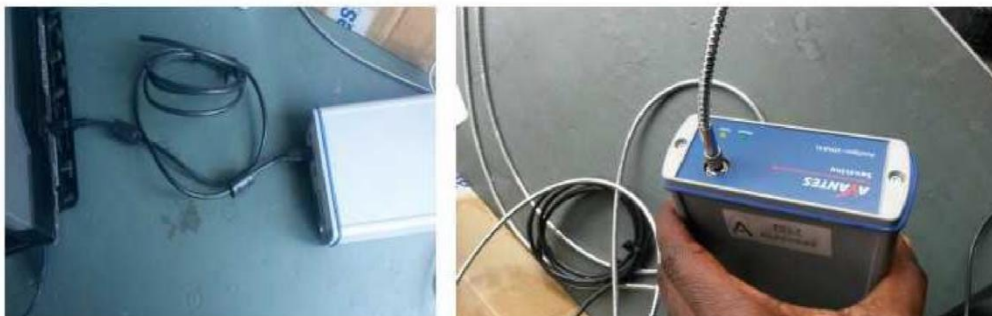
Figure 3. Connexion PC-spectromètre (a), connexion Fibre-spectromètre (b)
