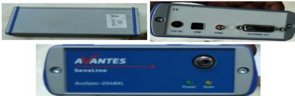
Figure 2. Le spectromètre AVANTES ULS2048XL-USB utilisé dans le système Kin-AeroDOAS
