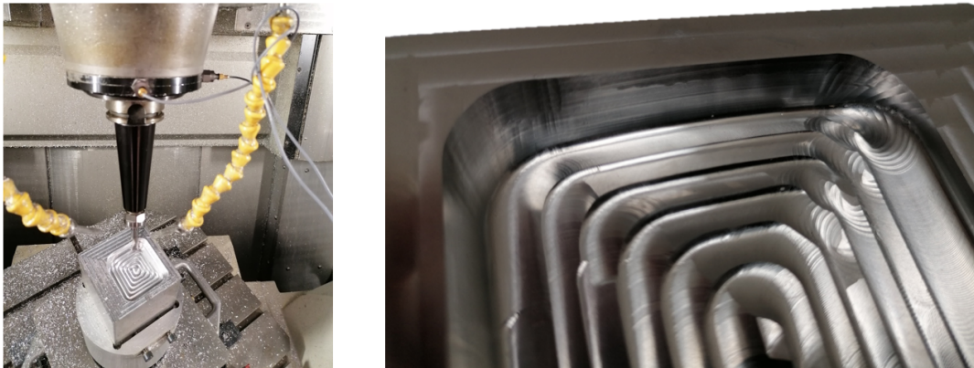
Figure 7 : Instrumentation de la broche et conséquences des vibrations dans les coins
