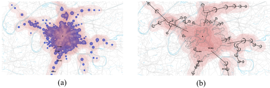
Figure 1: (a) exemple d'une carte isochrone d'accessibilité d'une zone urbaine en transports en commun: les zones atteignables de 10 à 25 min sont représentées grâce à un gradient de couleur. (b) carte isochrone simplifiée en utilisant des principes de généralisation cartographique lors de sessions de conception collaborative, afin de mettre en avant l'information essentielle telles que les zones homogènes en accessibilité (au centre) et les stations de métros (demi-cercles) le long du trajet des métros ou trains.
