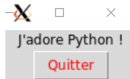
FIGURE 20.3 – Exemple basique de fenêtre Tkinter .
