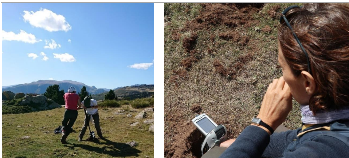
Figure 50 - A gauche réalisation d'un point de mesure avec une tarière manuelle de 20 cm de diamètre ; à droite, mesure avec l'XRF
