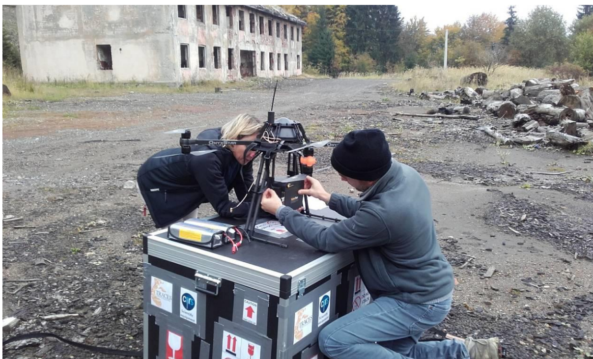
Figure 29 - Drone octorotor équipé d'un capteur Lidar (Yellowscan) – (Photo. V. Py)
