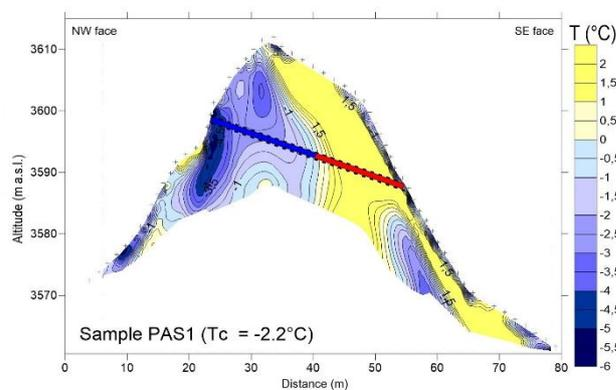
La distribution de température extraite de la conductivité électrique suggère une température d'environ  $-2^{\circ}\text{C}$  dans la face NO, ce qui est cohérent avec la température simulée numériquement à partir d'un capteur de température de surface (**Fig. 3**). Ce modèle de température suggère un permafrost proche du point de fusion et donc de possibles instabilités.
