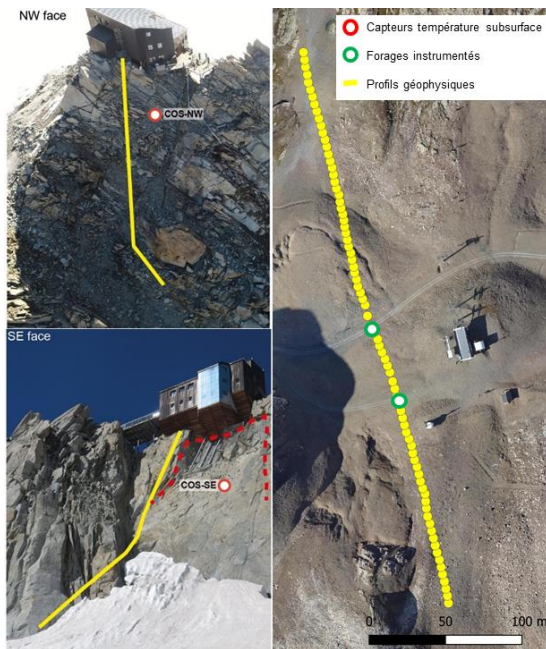
Fig. 1 – Carte de localisation des investigations géophysiques au refuge des Cosmiques (gauche) et télésiège de Bellecombes (droite).
