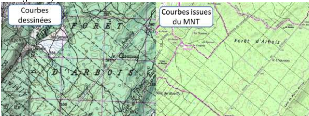
Figure 2. Courbes de niveau dessinées manuellement sur l'image du haut, générées à partir du MNT sur l'image du bas, dans un plateau rempli de dolines.
