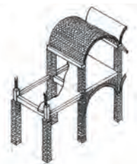
LA BRIQUE EN VALEUR Structure avec armature en béton armée; façades, arches et voûtes en brique
