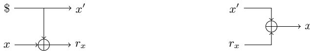
Fig. 1. Un circuit de masquage de x en x = (x', r_x) et son opération inverse. \$ dénote une valeur prise uniformément aléatoirement.
