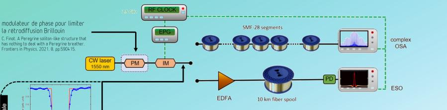
Le dispositif expérimental est totalement fibré et basé sur des dispositifs télécom.
