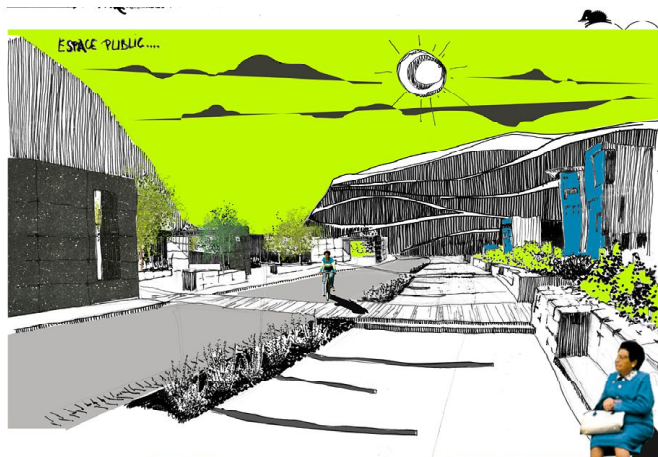
Hénilin-Carvin, Urban zip (pré-sélectionné). Vue perspective sur une voie desservant les logements : utilisation du schiste issu des terrils miniers pour le traitement de certains sols et de murets intégrant des bancs en bordure des trottoirs.
