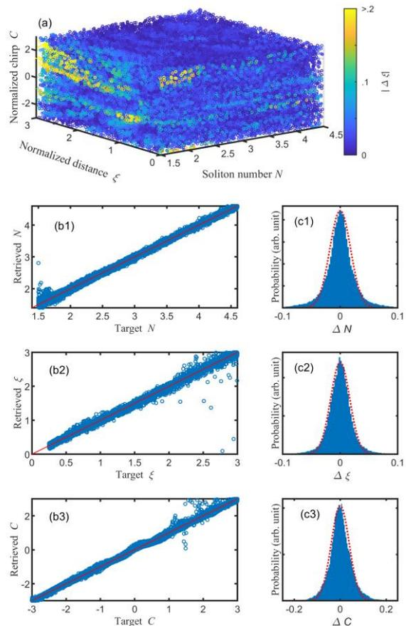
Fig. 2 : Problème inverse pour des impulsions initialement chirpées dans une fibre à dispersion normale. (a) Cartographie de l'erreur suivant  $N$ ,  $\xi$ ,  $C$ . (b) Comparaison des valeurs prédites par le réseau neuronal pour  $N$ ,  $\xi$  et  $C$  et des valeurs exactes. (c) Distributions statistique de l'erreur des erreurs sur  $N$ ,  $\xi$  et  $C$ . Les histogrammes sont comparés à une distribution normale (pointillés rouges).
