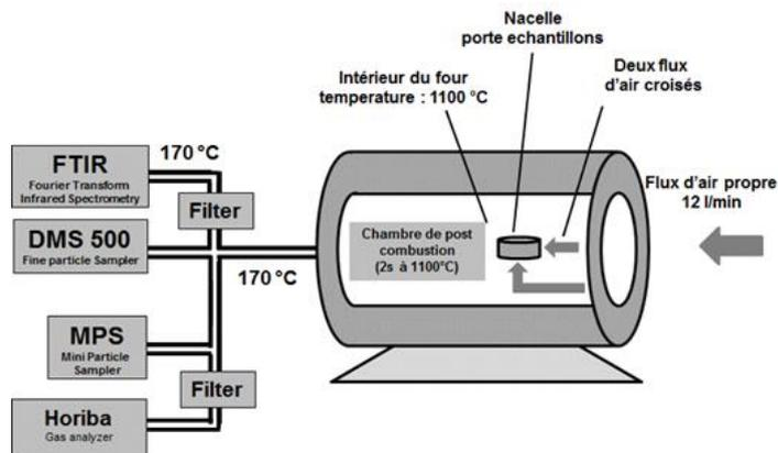
Figure 1. Présentation du dispositif expérimental
