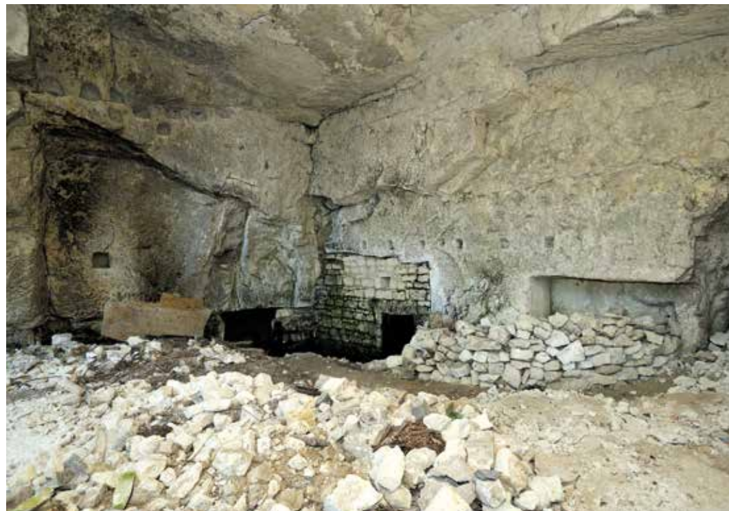
Carrière souterraine d'extraction de tuffeau de la Maumènière (site abandonné), chemin dit des Caves, Montsoreau. © Photo Conservation départementale du patrimoine de Maine-et-Loire, Youenn Commeneau et Bruno Rousseau.
