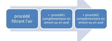
Les particules sont généralement éliminées par un filtre HEPA et le rendement du média filtrant est celui prévu par la norme et le type de filtre HEPA. Des procédés complémentaires sont parfois associés (rayonnements UV, procédés oxydants, préfiltre). Ceux-ci ne servent généralement qu'à nettoyer ou à protéger le filtre HEPA. Certains fabricants revendiquent parfois une protection de deuxième niveau.
