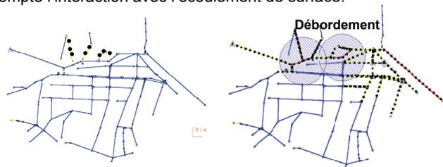
a) Sans interaction avec le réseau de surface      b) Avec interaction avec le réseau de surface
