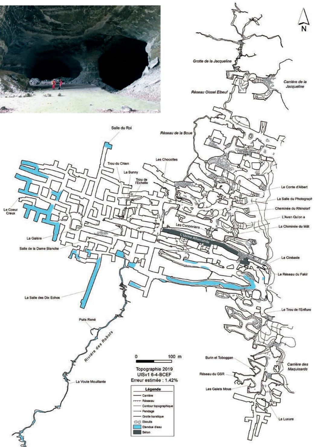
Figure 1 : carte des carrières et grottes de Caumont réactualisée grâce à un nouveau relevé spéléologique complet effectué en 2019.
