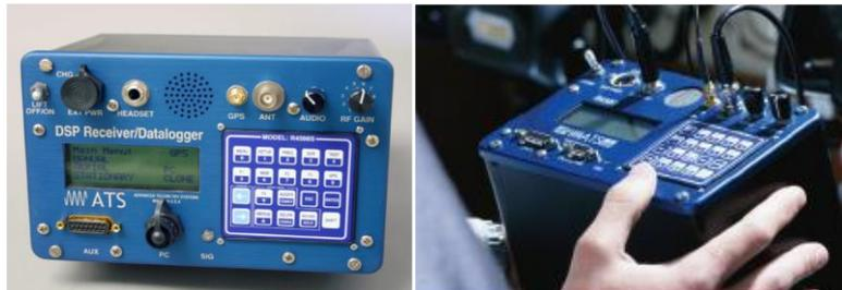
Figure 7 : Récepteur-enregistreur ATS, modèle R4500.
