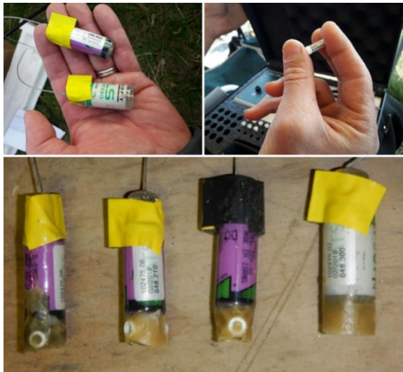
Figure 4 : Émetteurs radio (en haut à gauche), enregistreur de température miniature (en haut à droite) et leur combinaison avec de la cire d'abeille (biocompatible) (en bas). Les émetteurs sont activés en retirant l'aimant.
