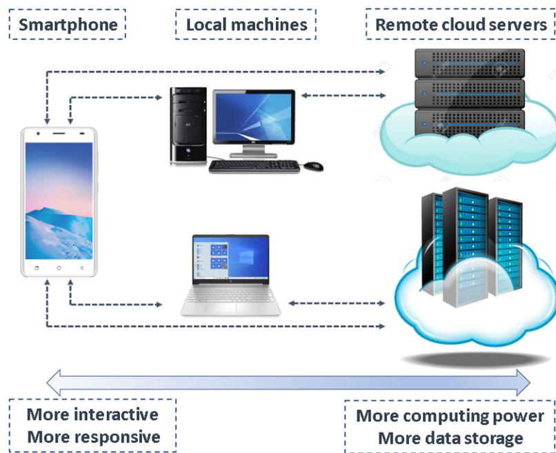
FIG. 2 – Communications possibles entre un smartphone et des machines locales/serveurs distants pour le traitement des données/la détection d'anomalies.
