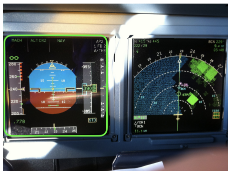
FIGURE 3: Proposition de conception : suivi du comportement visuel du copilote sur les instruments de vols à bord du cockpit (encadré vert)
