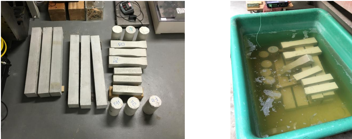
Figure 4 : Éprouvettes séchées (à gauche) et humides (à droite) d'après (Soleilhet, 2018)
