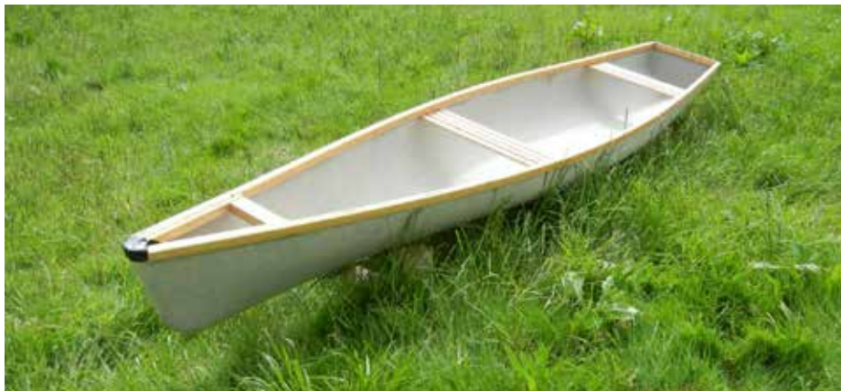
Figure 1 : Canoë en biocomposites réalisé à l'IRDL (UBS). Il est entièrement biobasé : coque en PLA/lin (matériau recyclable en fin d'usage et biocompostable en fin de vie) et finitions en bois (traitées à l'huile de lin).
