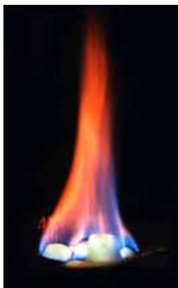
Figure 3. À gauche, photographie d'hydrate de méthane en flamme (© J. Pinkston & L. Stern, USGS). Ci-dessus, petite monticule de clathrates (avec léger dégazage) photographié par 4000 m de fond dans le Golfe du Mexique (© R. MacDonald, Texas A&M University-Corpus Christi.)
