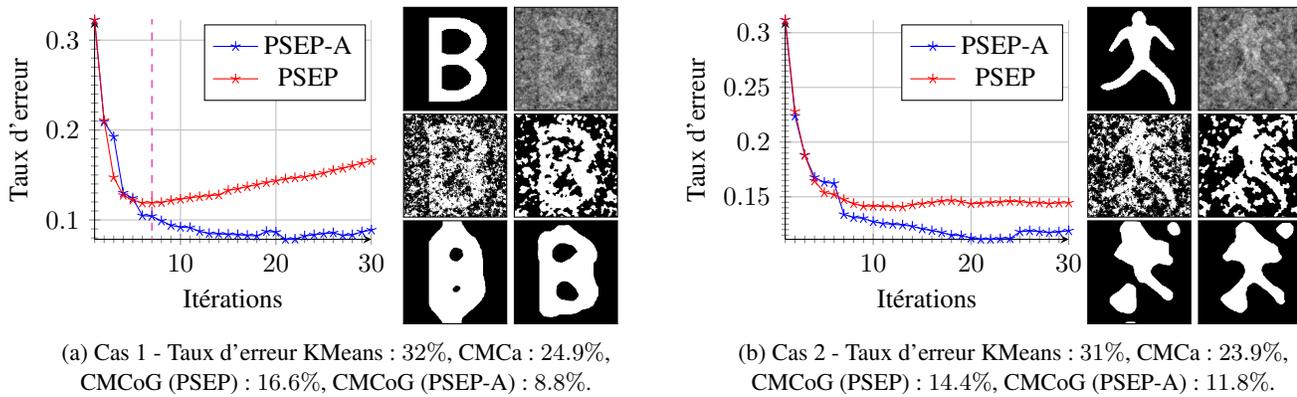
FIGURE 3 – Taux d'erreur des algorithmes dans la reconstruction *a posteriori* non-supervisée en fonction des itérations de l'algorithme d'estimation des paramètres pour le modèle CMCoG. Les images sont, de gauche à droite et de haut en bas : vérité terrain (inconnue), observations, segmentation KMeans, et les échantillons *a posteriori* en sortie de l'estimation des paramètres (après 30 itérations) pour CMCA (PSEP), pour CMCoG (PSEP) et pour CMCoG (PSEP-A).
