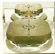
Porta pallet giratório, com sistema de troca de pallet
